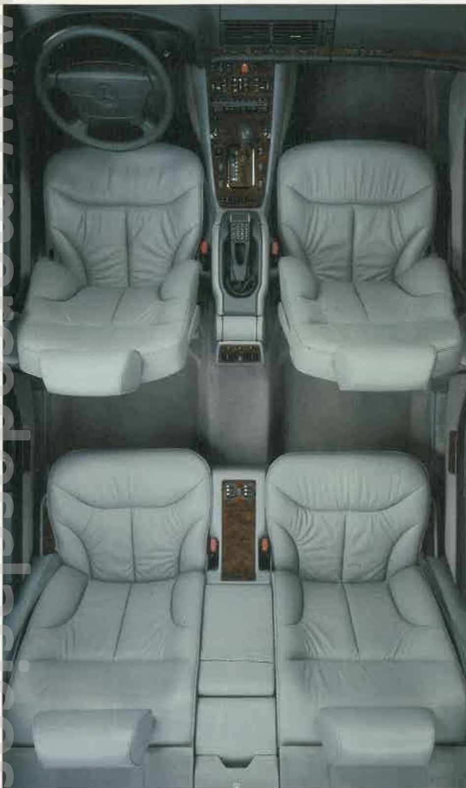
A LA CARTA. El interior se puede personalizar al gusto de cada uno. Las plazas posteriores son, bien para dos, bien para tres personas y reglaje individualizado en el primer caso. Dicho reglaje es en altura y longitud del asiento y en inclinación del respaldo.
